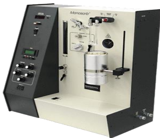
Figura 2.10. Instalație pentru studii de adsorbție pe materiale poroase:
